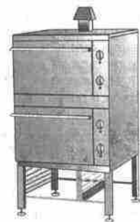
Рис. 10.21. Шафа електрична ЕШВ-2. Загальний вигляд
