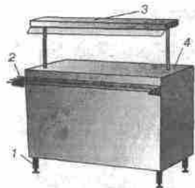
Рис. 11.21. Нейтральний прилавок: 1 — опора; 2 — бар'єр; 3 — полиця; 4 — отвір
