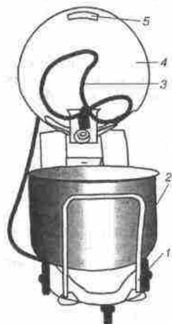
Рис. 6.5. Машина базова тістомісильна МВТМ-140: 1 — візок; 2 — бак; 3 — місильний важіль; 4 — сферична кришка; 5 — оглядове вікно
