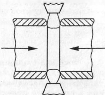
Рис. 8. Газопрессовая сварка
