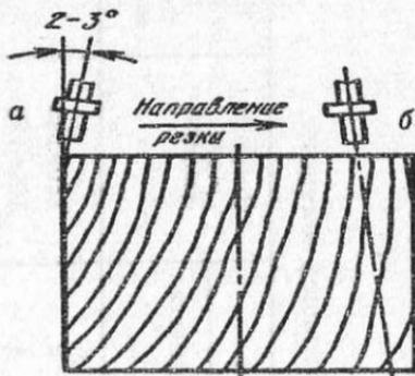
Рис. 90. Положения мундштука при резке стали большой толщины:
