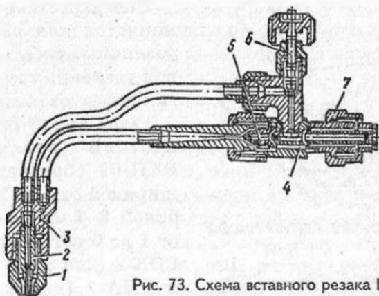
Рис. 73. Схема вставного резака РГС-70
