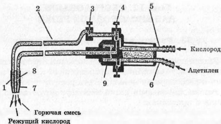
Рис. 71. Принципиальная схема инжекторного резака
