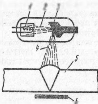
Рис. 129. Схема рентгеновского просвечивания:
