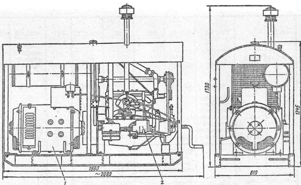
Рис. 106. Схема конструктивного исполнения сварочного агрегата АСБ-300:
