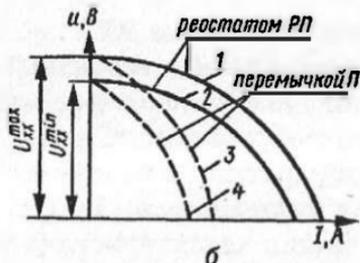
Рис. 108. Генератор с самовозбуждением и размагничивающей последовательной обмоткой:
