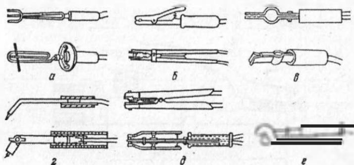
Рис. 18. Конструктивные схемы электрододержателей для ручной дуговой сварки:
