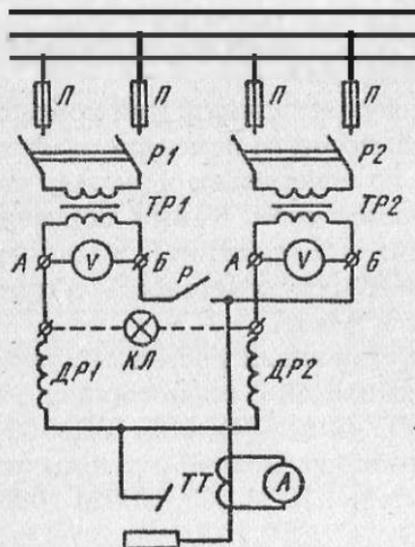
Рис. 117. Схема включения источника питания сварочного тока на параллельную работу: TP1 и TP2 — сварочные трансформаторы, КЛ — контрольная лампа, ДР1 и ДР2 — дроссели, ТТ — трансформатор тока, P1 и P2 — рубильники, П — предохранители
