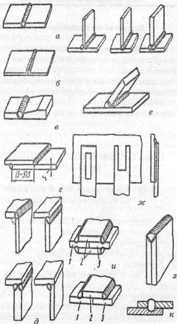
Рис. 30. Основные виды сварных соединений:
