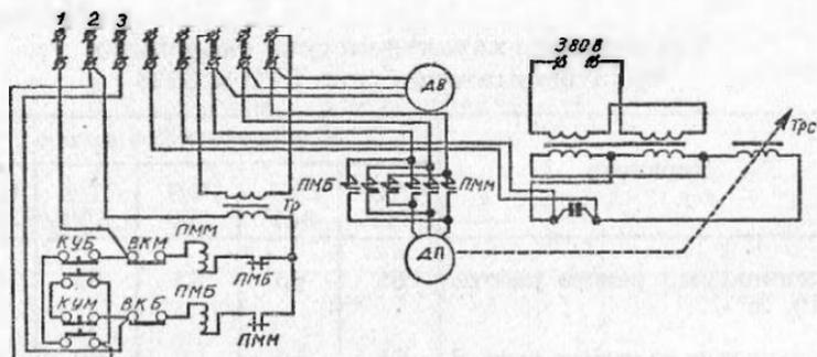
Рис. 102. Электрическая схема трансформатора ТСД-1000-3:
