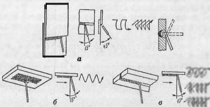
Рис. 51. Положение и движения электрода при сварке в горизонтальном и потолочном положениях:
