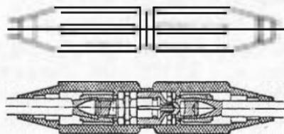
Рис. 21. Муфта для соединения сварочных проводов
