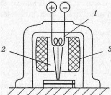
Рис. 5. Электронно-лучевая сварка
