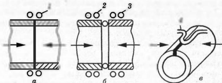
Рис. 16. Индукционная сварка
