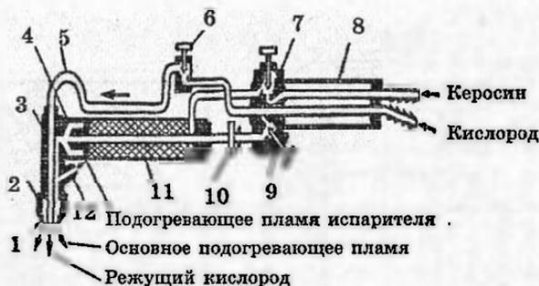
Рис. 77. Схема работы керосинореза
