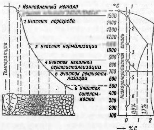
Рис. 29. Строение зоны термического влияния сварного шва
