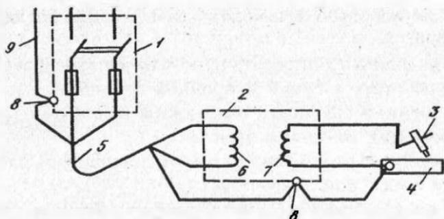
Рис. 138. Схема подключения сварочного трансформатора с питанием от сети с глухозаземленной нейтралью:
