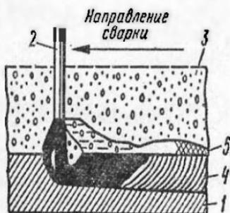
Рис. 122. Схема сварки под флюсом
