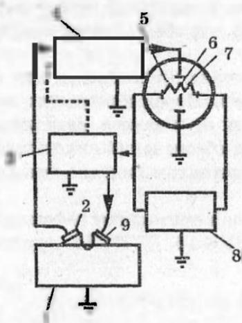
Рис. 132. Схема ультразвукового метода контроля сварных соединений:
