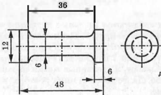
Рис. 135. Образец для испытаний механических свойств наплавленного металла
