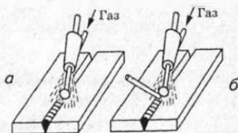
Рис. 4. Сварка в защитных газах
