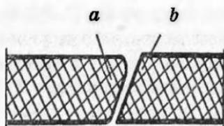
Рис. 86. Вид поверхностей (а, б) наклонного реза
