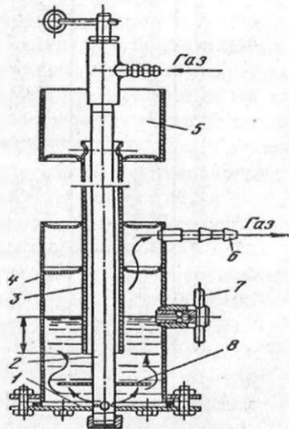
Рис. 56. Водяной затвор низкого давления открытого типа
