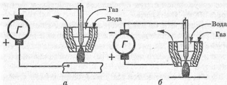
Рис. 95. Принципиальная схема процесса плазменно-дуговой резки:
