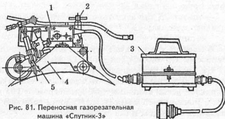
Рис. 81. Переносная газорезательная машина «Спутник-3»
