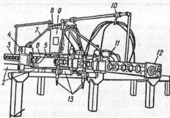
Рис. 83. Стационарная машина для резки СГУ-61:
