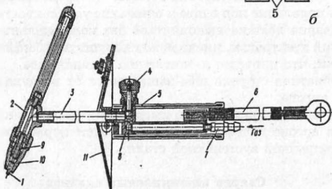
Рис. 126. Горелка для ручной аргонодуговой сварки вольфрамовым электродом:
