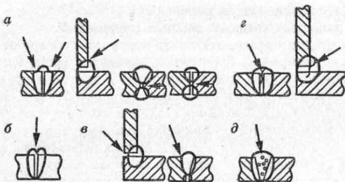
Рис. 128. Дефекты сварных соединений (стрелками указан дефект)
