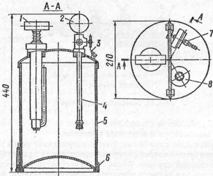
Рис. 78. Бачок для жидкого горючего:
