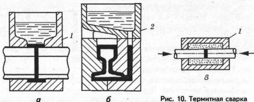
Рис. 10. Термитная сварка
