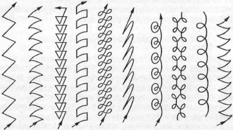
Рис. 44. Траектория движения конца электрода при наплавке уширенных валиков
