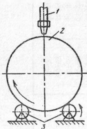
Рис. 89. Схема роликового стэнда для резки труб:
