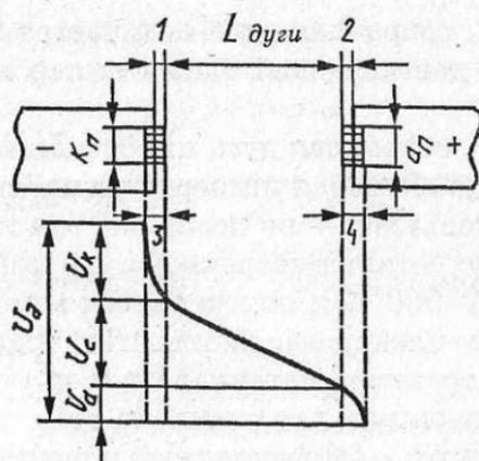
Рис. 25. Падения напряжения в дуге:
