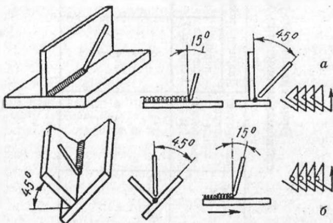
Рис. 49. Положение и движения электрода при сварке угловых швов:
