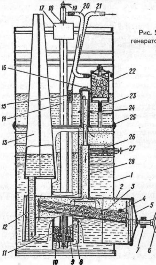
Рис. 55. Ацетиленовый генератор низкого давления АНВ-1,25-68
