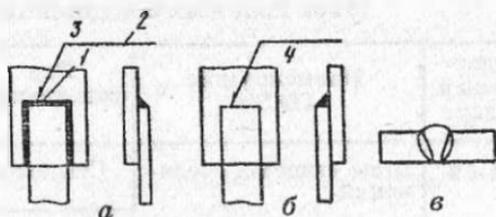
Рис. 34. Условное изображение сварных швов:
