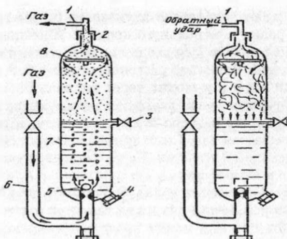
Рис. 57. Схема водяного затвора среднего давления закрытого типа:
