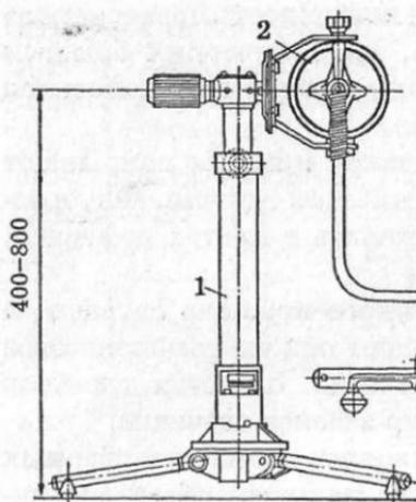
Рис. 130. Установка для промышленного просвечивания изделий гамма-излучением:
