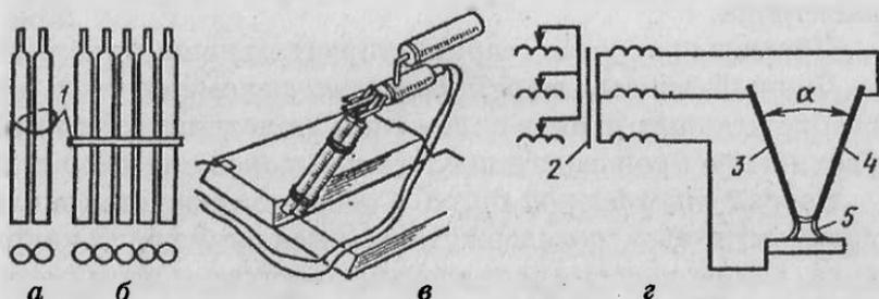
Рис. 52. Схема сдвоенного электрода (а), гребенки (б) и сварки трехфазным током (в, г):
