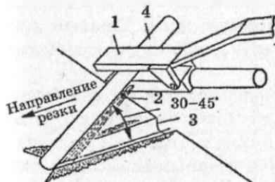
Рис. 93. Схема процесса воздушно-дуговой резки:
