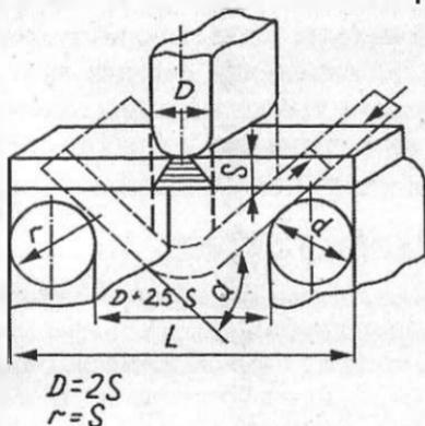
Рис. 137. Образец для испытаний механических свойств на изгиб
