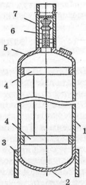
Рис. 59. Баллон для пропан-бутана
