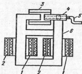
Рис. 100. Конструктивная схема трансформатора типа СТН:
