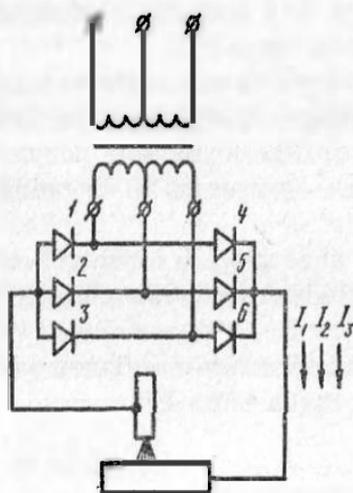
Рис. 112. Трехфазная схема выпрямления переменного тока: 1-6 — полупроводниковые вентили (диоды)
