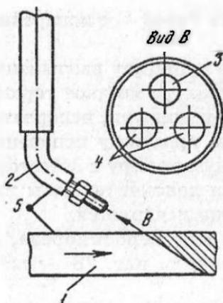
Рис. 75. Схема резки «смыв»-процессом:
