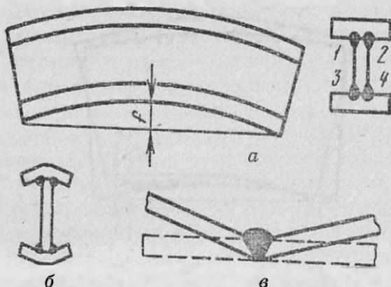
Рис. 39. Деформации вне плоскости сварных соединений:
