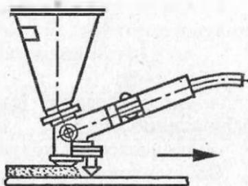
Рис. 123. Схема полуавтоматической сварки под флюсом стыковых швов
