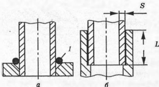
Рис. 15. Печная сварка
