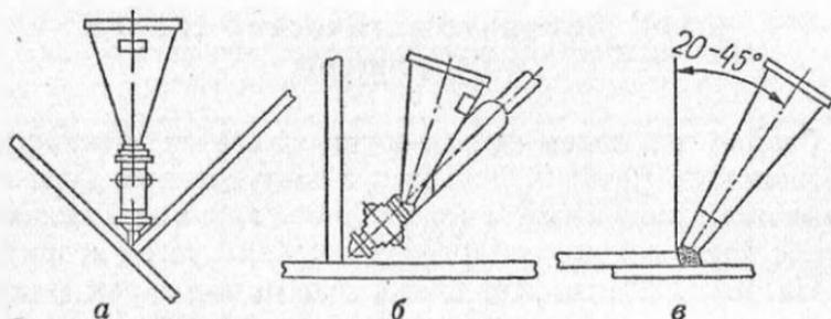
Рис. 124. Схема полуавтоматической сварки под флюсом:
