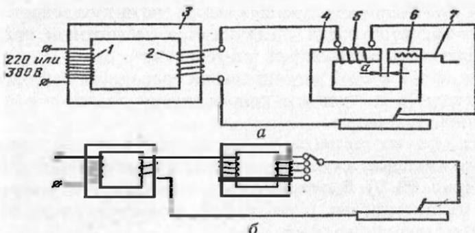
Рис. 99. Принципиальная электрическая схема сварочных трансформаторов с отдельными дросселями:
