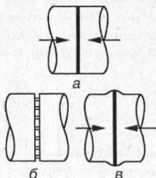
Рис. 9. Контактная сварка
