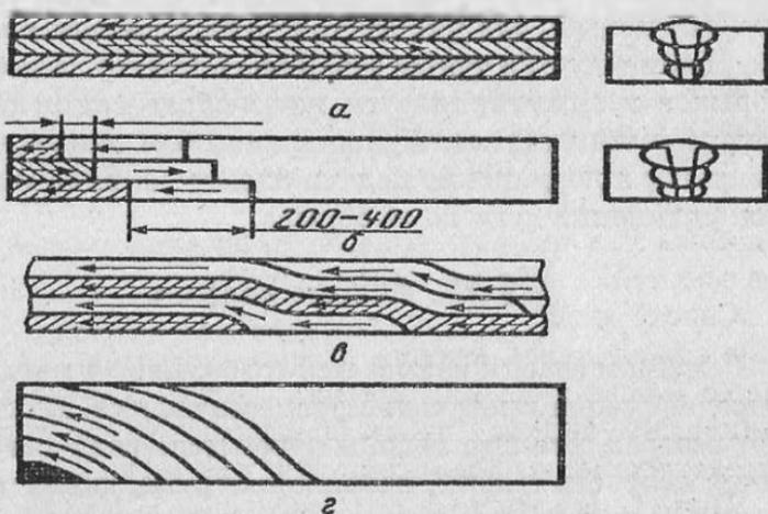
Рис. 46. Схемы заполнения многослойного шва с малым интервалом времени:
