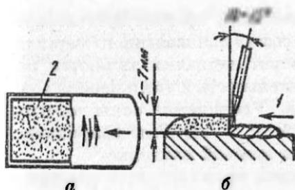
Рис. 96. Положение угольного электрода в процессе наплавки порошкообразных твердых сплавов:
