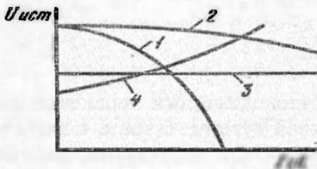
Рис. 97. Виды внешних вольт-амперных характеристик источников питания дуги:
