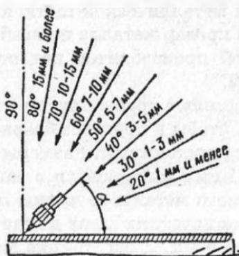
Рис. 67. График угла наклона мундштука горелки
