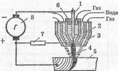
Рис. 94. Принципиальная схема процесса плазменно-дуговой резки:
