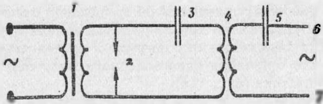
Рис. \*16. Электрическая схема сварочного осциллятора
