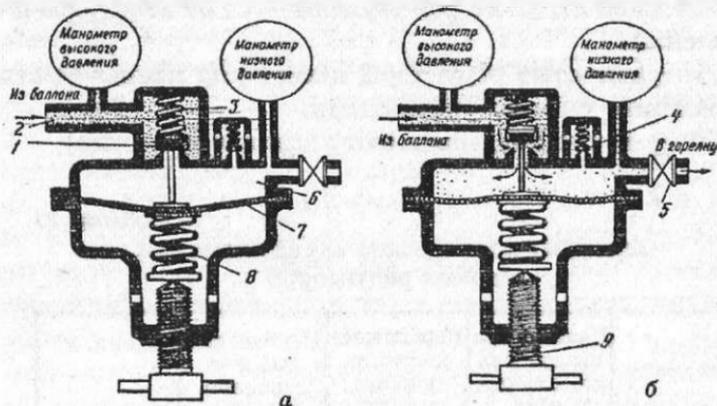
Рис. 60. Схема устройства и работы редуктора:
