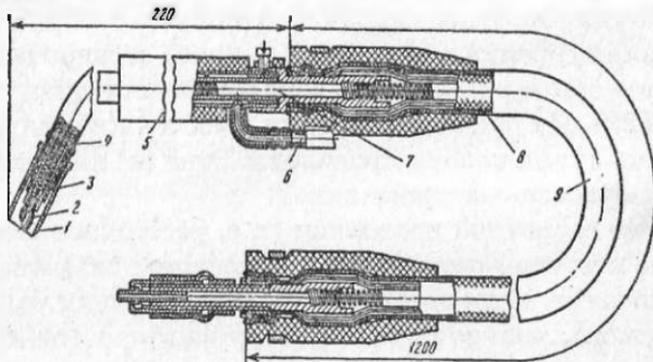
Рис. 120. Горелка легкого типа полуавтомата А-547У:
