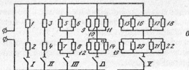
**Балластные реостаты.** На рис. 111 показана электрическая схема балластного реостата типа РБ.
