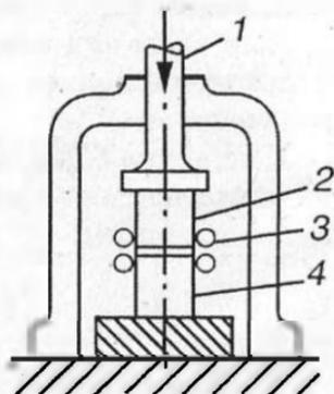
Рис. 11. Диффузионная сварка
