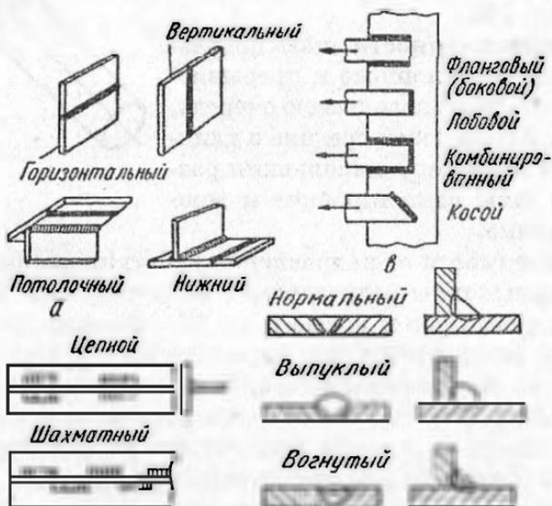
Рис. 31. Классификация сварных швов:
