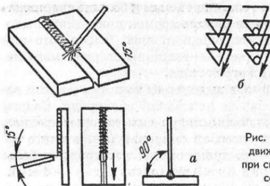
Рис. 48. Положение (а) и движения электрода (б) при сварке стыковых швов со скосом кромок
