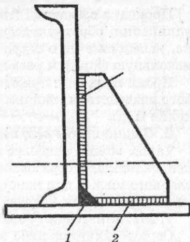
Рис. 41. Правильная последовательность сварки узла:
