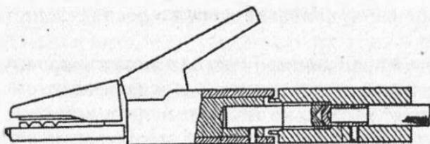
Рис. 19. Электродержатель, оборудованный системой ручного отключения тока
