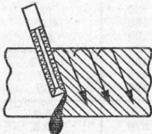
Рис. 91. Схема резки металлическим электродом
