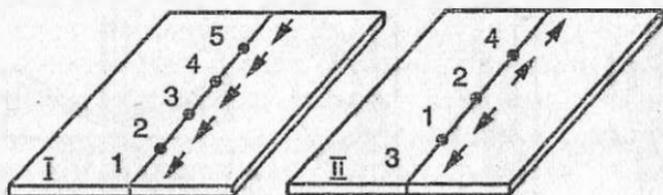
Рис. 69. Порядок наложения швов:
