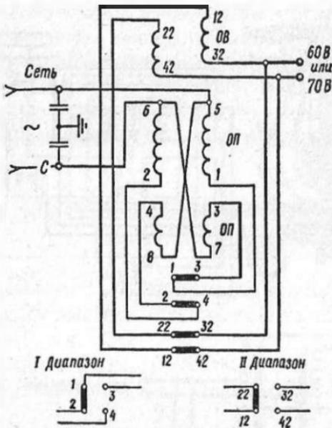
Рис. 104. Схема сварочного трансформатора типа ТД-500
