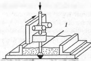
Рис. 3. Автоматическая дуговая сварка под слоем флюса
