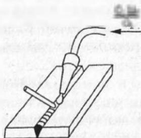
Рис. 7. Ацетиленокислородная сварка
