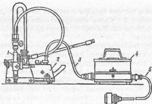
Рис. 79. Переносная машина для кислородной резки «Микрон-2»
