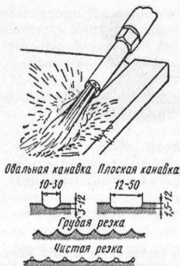
Рис. 74. Схема поверхностной кислородной резки и формы выплавляемых канавок
