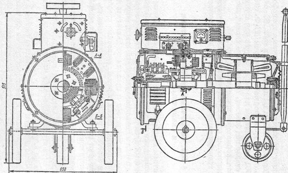
Рис. 105. Конструктивное оформление преобразователя ПСГ-500
