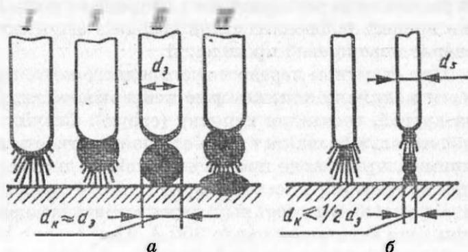
Рис. 27. Процесс переноса электродного металла на изделие при короткой дуге:
