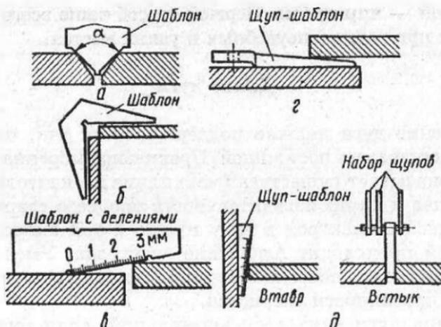
Рис. 42. Инструмент для проверки качества сборки:
