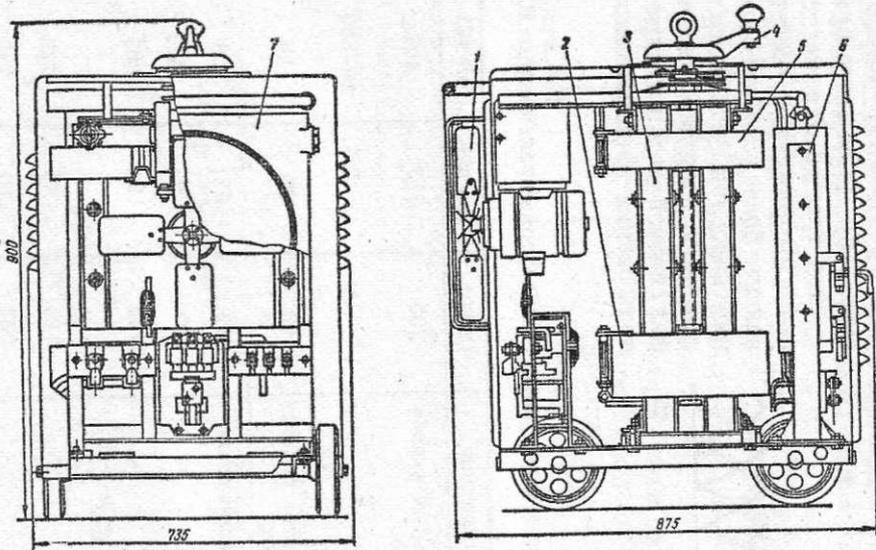
Рис. 115. Конструктивное исполнение сварочного выпрямителя ВСС-300:
