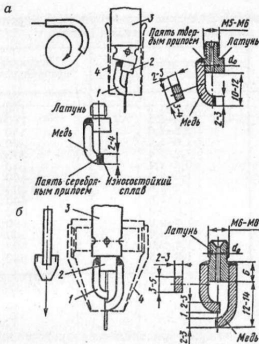
Рис. 121. Контакты держателя для изогнутых (а) и прямых (б) мунштуков при сварке проволокой 0,5—1,2 мм: 1 — контактный сапожок, 2 — наконечник, 3 — мунштук, 4 — сопло
