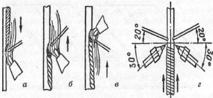
Рис. 70. Сварка вертикальными швами:
