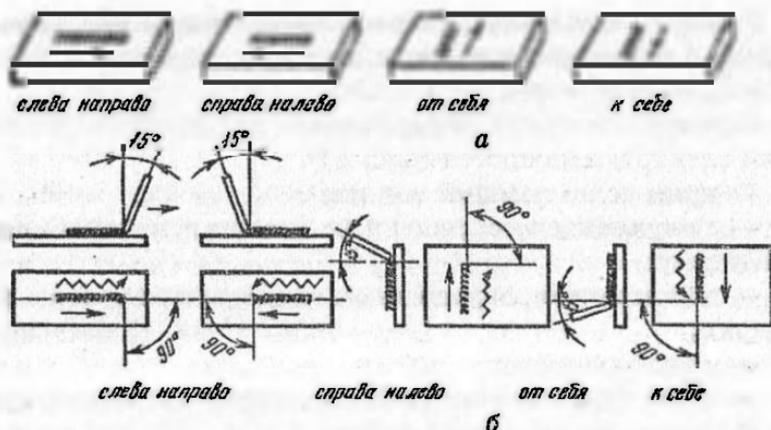
Рис. 43. Направления сварки (а) и наклон электрода (б)
