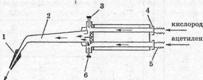
Рис. 63. Схема безынжекторной горелки
