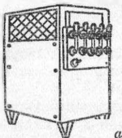
Рис. 111. Балластный реостат типа РБ:
