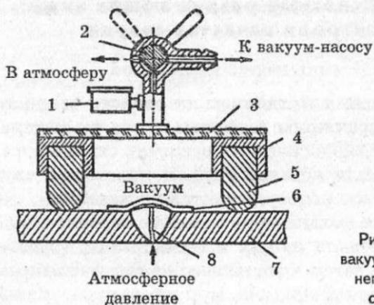
Рис. 134. Схема вакуумного контроля непроницаемости сварного шва
