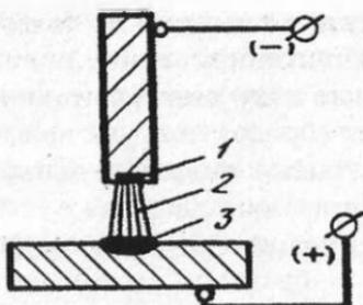
Рис. 24. Схема строения сварочной дуги:
