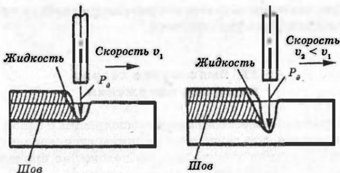
Рис. 47. Схема сил взаимодействия между дугой и жидкостью в хвосте сварочной ванны:  $P_a$  — давление дуги
