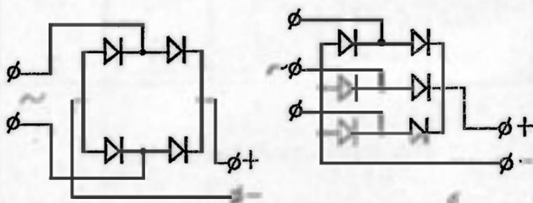
Рис. 113. Принципиальные типовые схемы выпрямителей: а — однофазная мостовая, б — трехфазная мостовая
