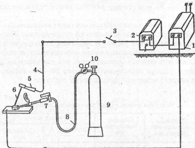
Рис. 92. Схема оборудования поста для кислородно-дуговой резки стальным стержневым электродом:
